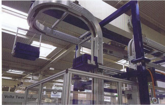
Das Fördertechniksystem „Quick-Move“ ist eine Maßnahme gegen den Platzmangel im Lager.
