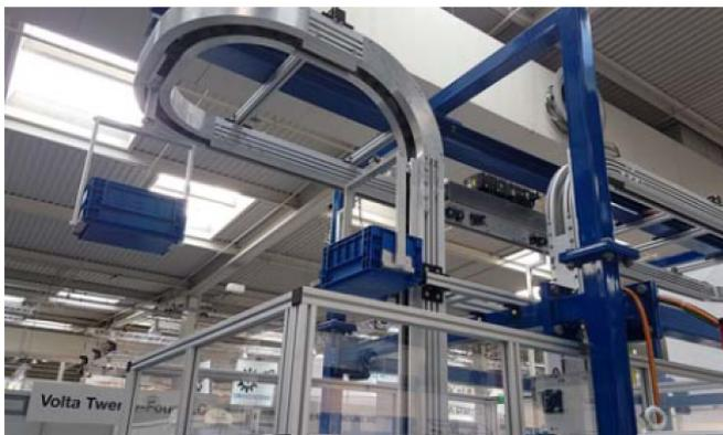
Platzsparend durch rechten Winkel in die Höhe und zur Seite: Das Fördersystem Quick Move schafft Richtungswechsel ohne Umladen oder anderes Handling. Bild: Quick Move
